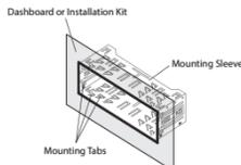
Paso 3: Conectar todos los arneses de cableado y deslizar la unidad principal en la manga de montaje hasta que haga click.
