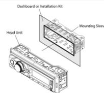
Paso 4: Retire las tapas de plástico y use las teclas de extracción para quitar la unidad.
