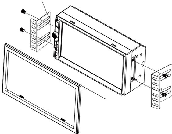
Método típico de montaje de carga frontal
