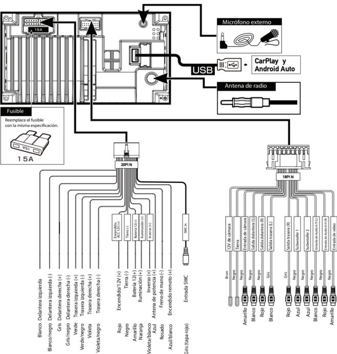
**Nota:** Cuando reemplace un fusible, asegúrese de usar el tipo y amperaje correcto. Usar un fusible incorrecto podría dañar la unidad. La unidad utiliza (1) fusible tipo mini ATC de 15 amperes que se encuentra en el conector de alimentación.
